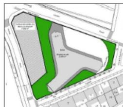
Scénario de restructuration lourde et extension du bâtiment tour, avec démolition des bâtiments annexes et démolition partielle du parking existant sous l'emprise du futur terrain de l'école. La restructuration s'accompagne d'une rénovation thermique du bâtiment. Complément de surfaces tertiaires sur un autre site pour répondre au programme de l'État. Implantation d'une nouvelle école sur une partie de la parcelle.
