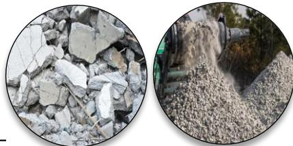
Transformation ex-situ des bétons en granulats
